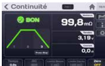
Test Bon terminé
